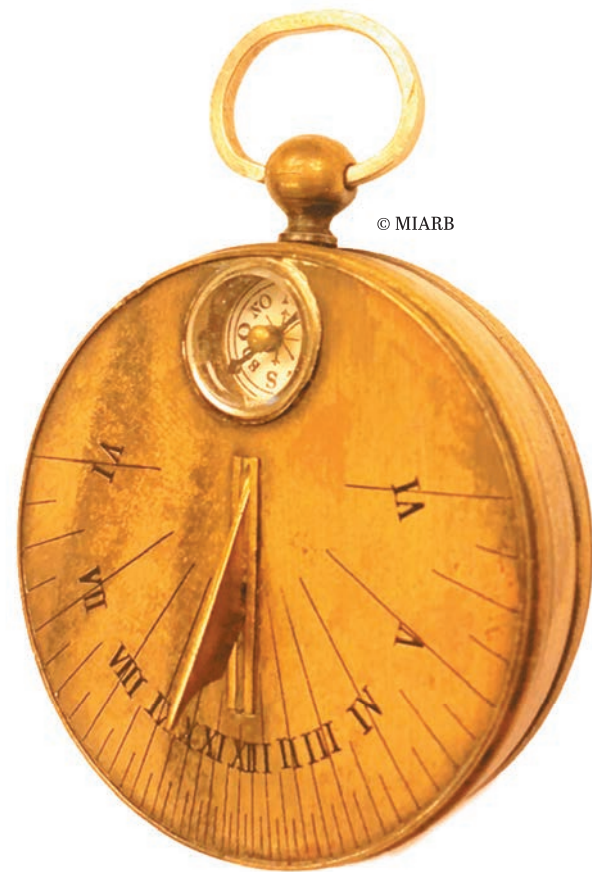
Anónimo. S. XVIII, circa 1730 Reloj solar portátil muy inusual; estilo lepine sobredorado, dotado de brújula y gnomon abatible. Realizado en Nuremberg, Alemania, para el mercado español.
